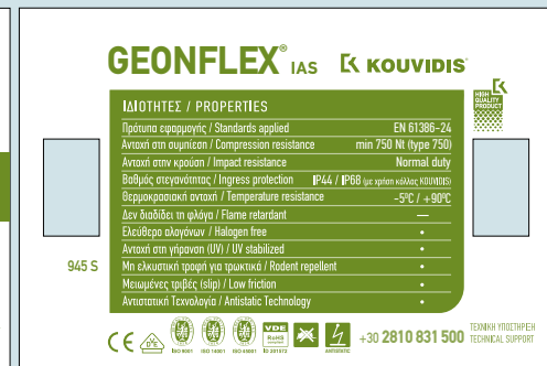
Ετικέτα που χρησιμοποιείται για τους σωλήνες διπλού δομημένου τοιχώματος (διπλής όψευας)
